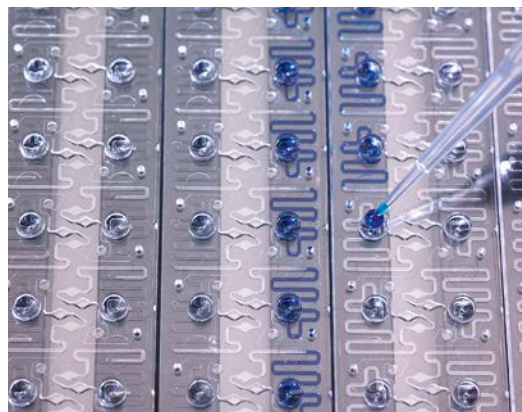
Trinean Chip zur Messung der DNA Konzentration Bild: STRATEC
