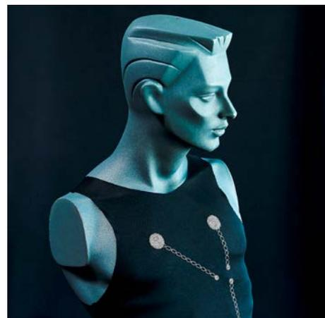
Sensorshirt mit gestickten Elektroden zur Vitaldatenerfassung Bild: Texible GmbH
