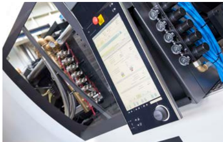
Integrierte Systemlösungen aus einer Hand: die CC300 Steuerung der Spritzgießmaschine ist das zentrale Bedienpanel für die gesamte Fertigungszelle. Bild: ENGEL
