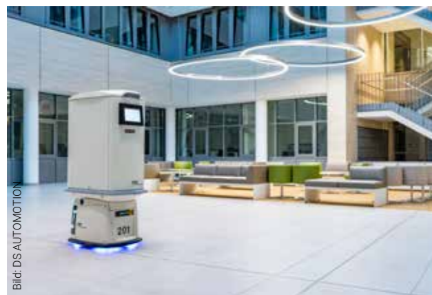
Mit der neuen Navigationstechnologie von DS AUTOMOTION transportiert der Sally Kurier autonom und unfallfrei Laborproben, Dokumente und Medikamente im Krankenhaus. Bild: DS AUTOMOTION
