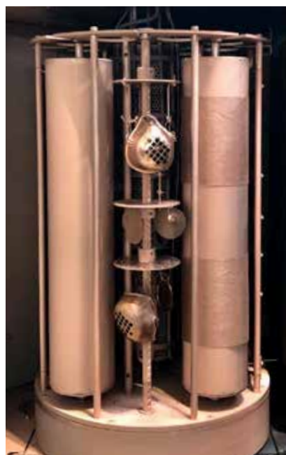
Blick in die PVD-Anlage nach erfolgreichem Beschichtungsprozess Bild: RÜBIG GmbH & Co KG
